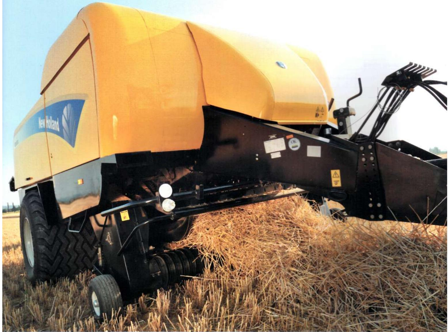
Машины серии BB9000 оснащены подборщиками SiperSweep™, отличающимися высокой продуктивностью и настолько бережным обращением с урожаем, что меж их подъемными зубьями не проскользнуть и соломинке. Пневматические копирующие колеса позволяют придерживаться оптимальной высоты даже при работе с высокой путевой скоростью.
